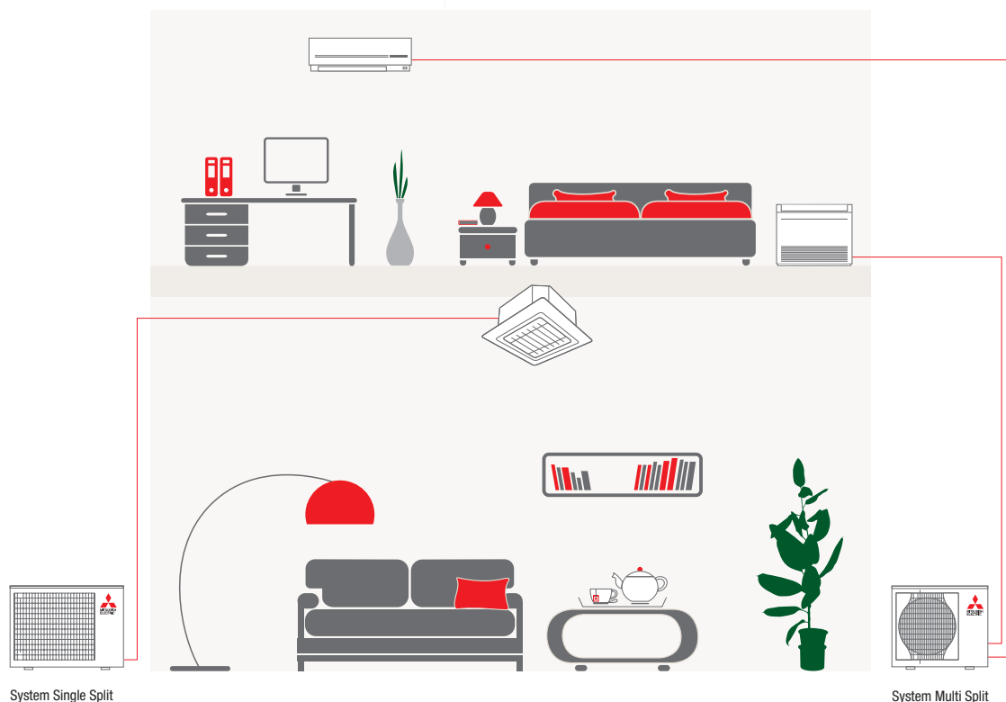
Instalacje Single Split i Multi Split
