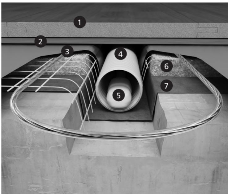
Sposób umieszczenia czujnika temperatury
