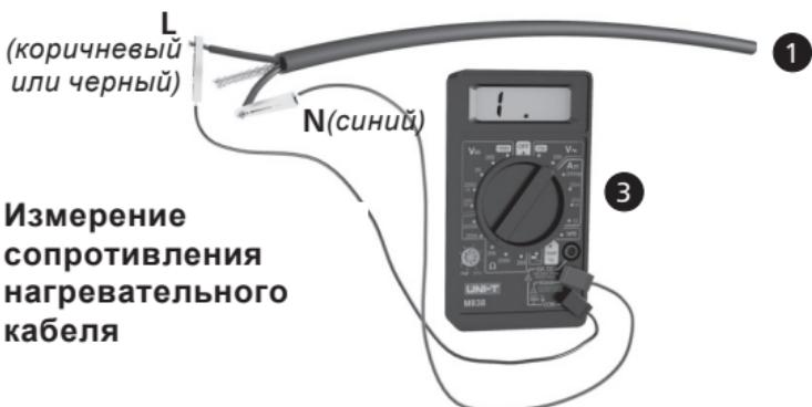
**Измерение сопротивления нагревательного кабеля**
